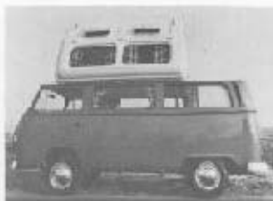
uitvoering met Domobile dak en 2 extra slaapplekken in het dak
